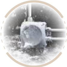
WP系列: IP 66 / IP 68 / IP 69 水下20米深处浸泡168个小时试验, 全防护、完全防水,要在盒内灌胶 适应极端环境下的应用, 带接线端子, 有公制敲落孔
