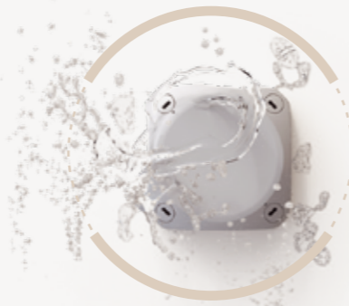
WP 系列: IP 66 / IP 68 / IP 69 浸没深度 20 米, 168 小时 防水, 用于灌封的公制敲落孔
