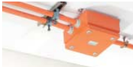
Kabel-/Leitungsanlage vor Brandprüfung zum Funktionserhalt: Geprüft wird im System, d.h. Kabelabzweigkästen mit Befestigungsmaterial, Kabeln / Leitungen, Tragkonstruktionen etc.
