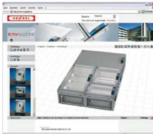
KV-Kleinverteiler 3 bis 54 Teileinheiten, IP 54-65
