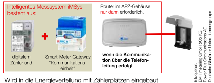
Wird in die Energieverteilung mit Zählerplätzen eingebaut
