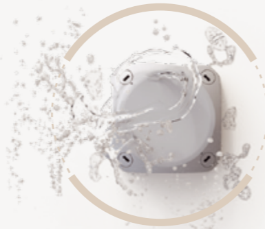
WP-Serie: IP 66 / IP 68 / IP 69 Untertauchen bis 20 Meter, 168 Stunden wasserdicht, zum Vergießen metrische Vorprägungen
