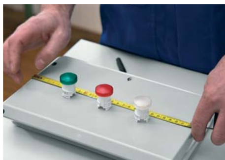
Einbaugeräte auswählen. Maße übertragen und anzeichnen.
