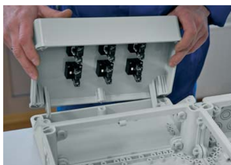
Scharnierte Einbaufläche der Connection Box einschwenken und verschrauben.
