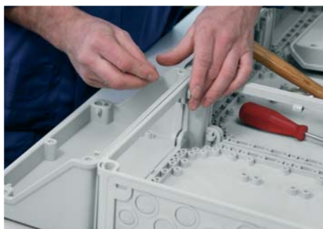
Anbau des Unterteils einer Connection Box mit Keilverbindungen an den Mi-Verteiler.
